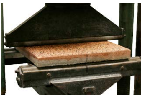
DLAŽBA PRI SKÚŠKE PEVNOSŤ V OHYBE
