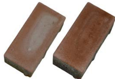
Povrch dlažby s vápenným výkvetom pred čistením a po vyčistení Rebanitom S
