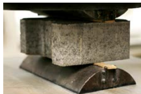
DLAŽBA PRI SKÚŠKE PEVNOSŤ V PRIEČNOM ŤAHU
