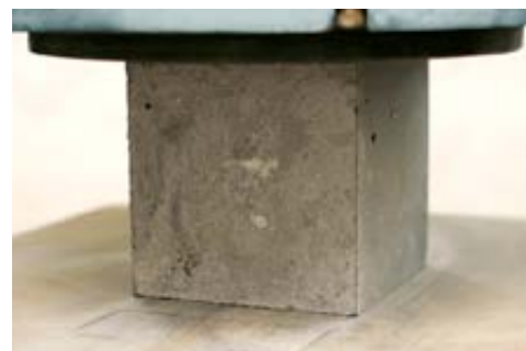
BETÓN PRI SKÚŠKE PEVNOSŤ V TLAKU
