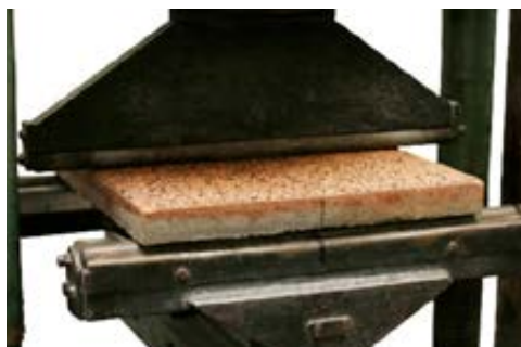
DLAŽBA PRI SKÚŠKE PEVNOSŤ V OHYBE
