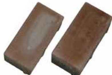
Povrch dlažby s vápenným výkvetom pred čistením a po vyčistení Rebanitom S
