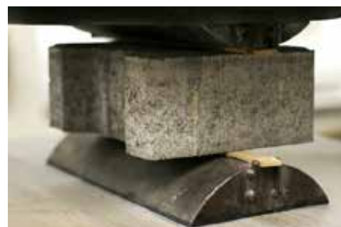
DLAŽBA PRI SKÚŠKE PEVNOSŤ V PRIEČNOM ŤAHU
