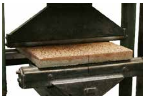
DLAŽBA PRI SKÚŠKE PEVNOSŤ V OHYBE
