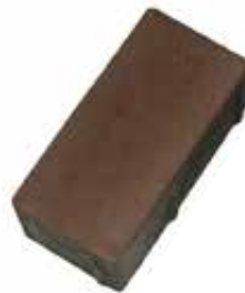
Povrch dlažby bez vápenného výkvetu
