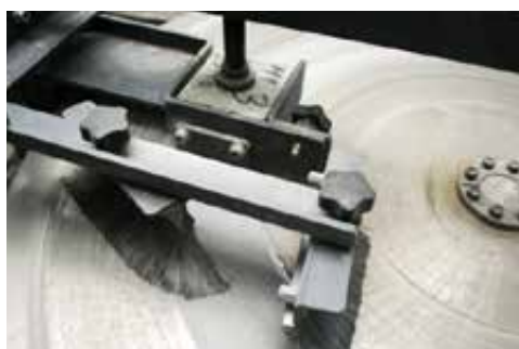
DLAŽBA PRI SKÚŠKE OBRUSNOSŤ POVRCHU
